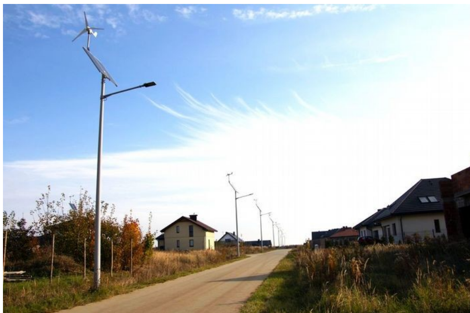
Rysunek 14: Oświetlenie hybrydowe na Osiedlu Czerwony Kamień w Górze Siewierskiej
